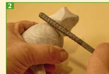
Mit der Rundraspel lassen sich gut Rillen oder Kahlen schleifen.
