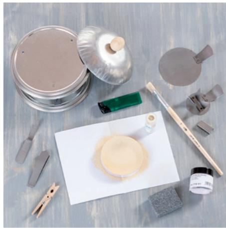
**1** Die Vorderseite des Kupferrohlings mit dem Schleifblock säubern. Das Haftmittel auf den Kupferrohling auftragen und trocknen lassen. Es sollte trocken aber noch klebrig sein. Den Rohling auf die U-Schiene legen und anschließend gleichmäßig deckend mit dem elfenbeinfarbenen Efcolor Farbschmelzpulver bestreuen. Den Kupferrohling auf die Brennpfanne legen und in den vorgeheizten Efcolor-Ofen legen. Nach 3-5 Minuten mit Hilfe einer Holzklammer aus dem Ofen nehmen. Abkühlen lassen.
